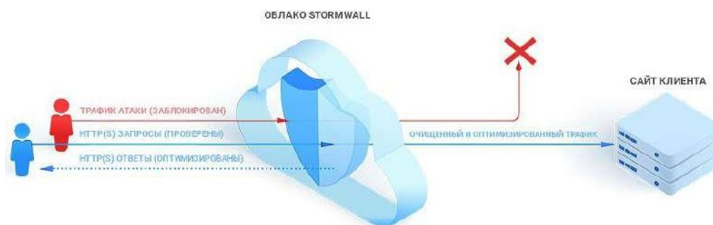
Сурет 3. Үшінші тарап қызметі арқылы DDoS шабуылдарынан қорғау схемасы.
