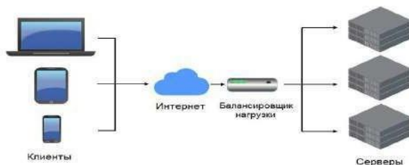
Сурет 2. Жүктемені теңестіру арқылы клиенттердің сервер ресурстарына қол жеткізу схемасы.
